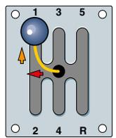
1<sup>re</sup> et 2<sup>e</sup> vitesses: faible allure, puissance élevée.
